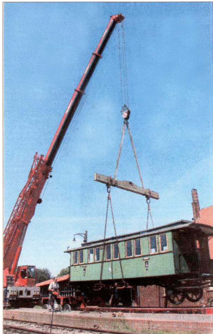
Vorsichtig, ganz vorsichtig: Mit viel Gefühl wird der historische Museums-Waggon mit dem Kran auf den bereitstehenden Tieflader gehievt. Fotos: BECKER
