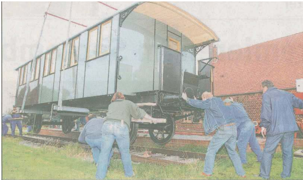
Ein 60-Tonnen-Mobilkran hebt den 12,5 Tonnen schweren Waggon vom Sattelschlepper auf das Gleisstück im LWL-Industriemuseum Ziegelei Lage. Foto: Lambracht
